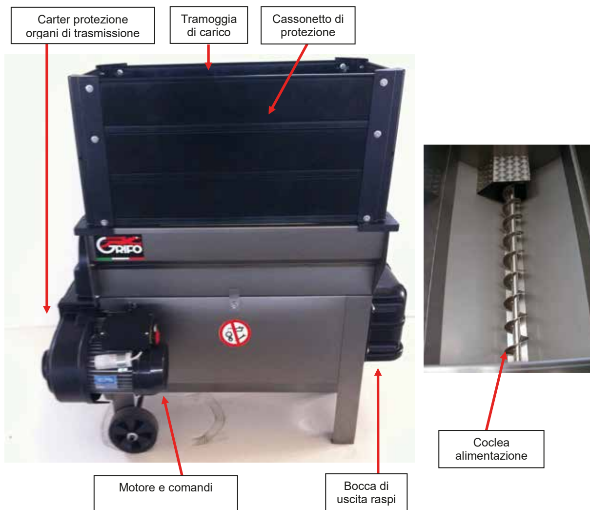
Fig. 1 Elementi fondamentali della DIRASPATRICE VASCA E POMPA
